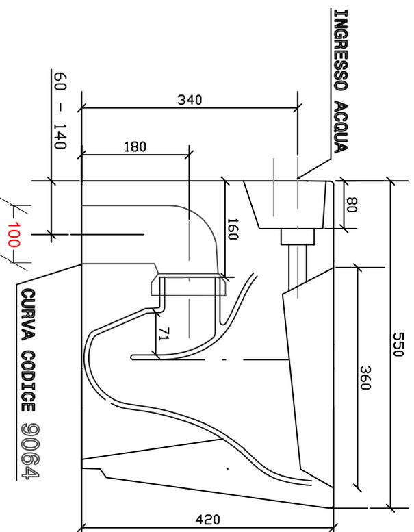
SCARICO PAVIMENTO 160mm - 200mm
